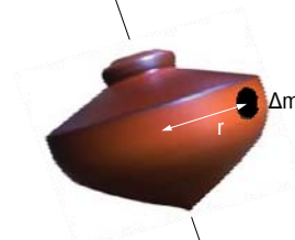
Gambar 21. Ilustrasi momen inersia pada elemen massa ( \Delta m ) gasing yang berputar pada sumbu rotasinya.
