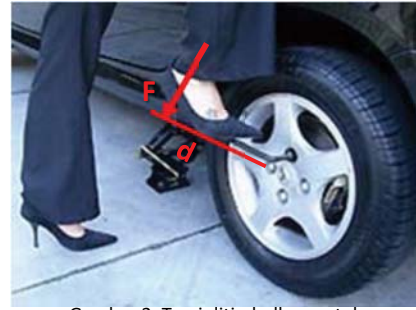
Gambar 3. Torsi ditimbulkan untuk membuka baut dengan mudah
