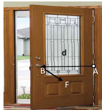
Gambar 2. Torsi ditimbulkan membuka pintu dengan mudah
