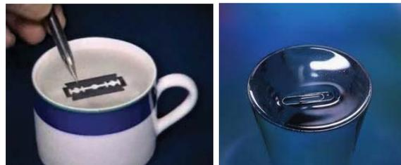
Gambar 21 Silet dan paper clip dapat terapung di permukaan fluida karena adanya tegangan permukaan.
