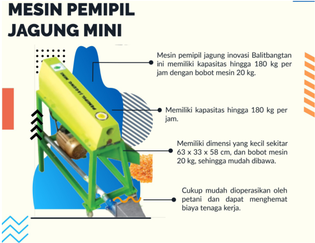
Gambar 12.1 Mesin Pemipil Jagung Mini Sumber: http://repository.pertanian.go.id/handle/123456789/9332
